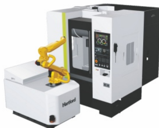
S-PLUS 8 adagoló robottal
