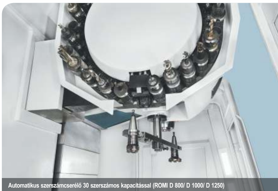
Automatikus szerszámcsereő 20 szerszamos kapacitással (ROMI D 600)
